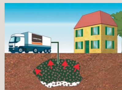
Phase 3 : clavage et mise en compression de la calotte
