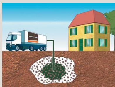
Phase 2 : injection de la résine expansive et diffusion entre les billes d'argile
