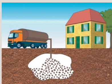
Phase 1 : comblement avec l'argile expansée
