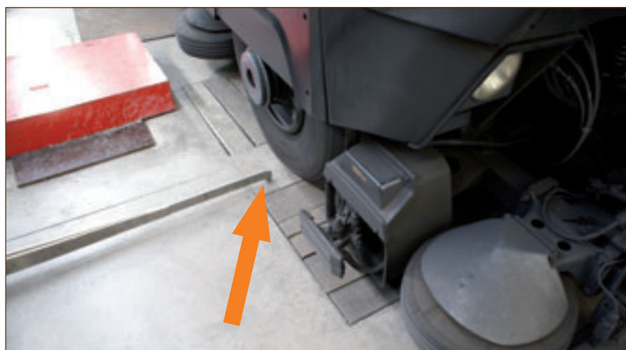
Pointe de la poutre de Benkelman le long du boggie de la rame de métro
