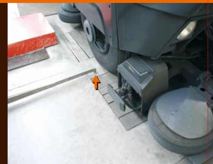
Pointe de la poutre de Benkelman le long du boggie de la rame de métro.
