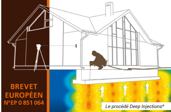
URETEK® est la référence en injection de résine expansive en profondeur pour la consolidation de sols, la stabilisation de bâtiments ainsi que le renforcement de maçonneries.
